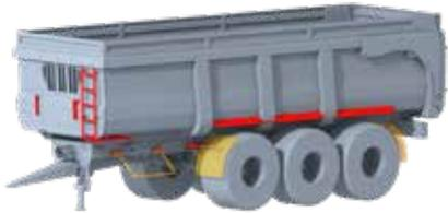
**Einklappbare Aluminiumleiter, verzinkte seitliche Kotflügel und Vorrichtungen für optionale Ausrüstungen** (seitlicher Auffahrschutz und thermoplastische Kotflügel).
